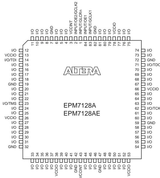
**Figure 17. 100-Pin TQFP Package Pin-Out Diagram**
