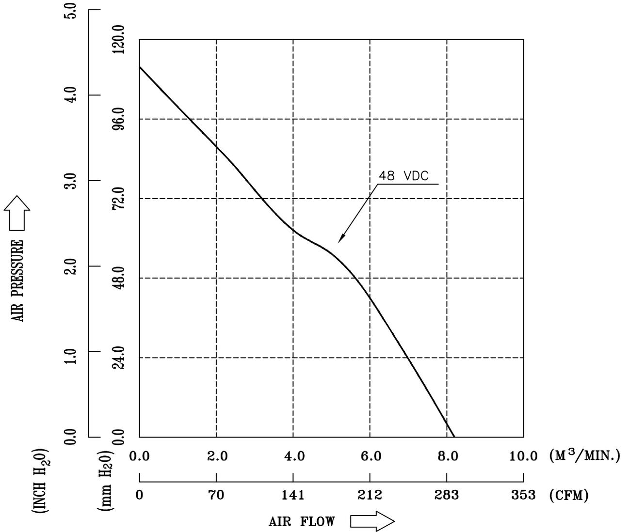
\* TEST CONDITION: INPUT VOLTAGE ----- OPERATION VOLTAGE
