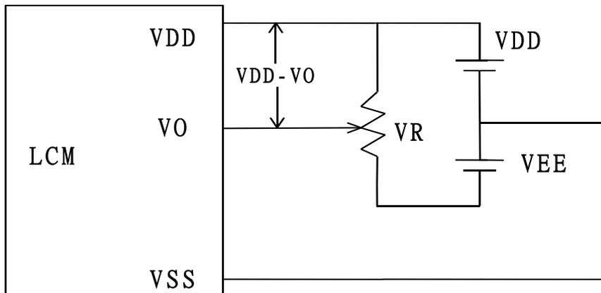
$V_{DD}-V_O$  : LCD Driving Voltage
