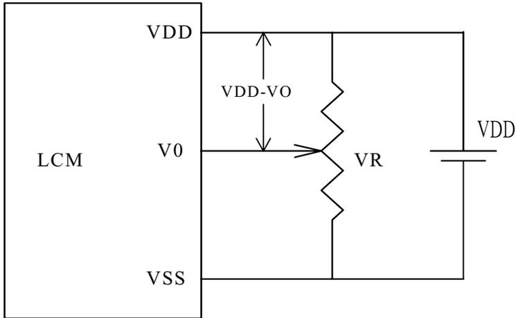
$V_{DD}-V_O$  : LCD Driving Voltage
