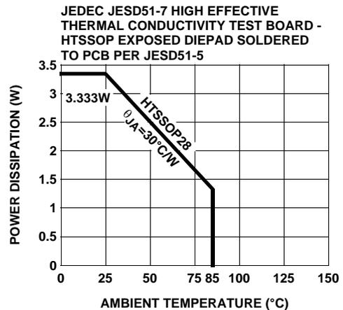
FIGURE 12. POWER DISSIPATION vs AMBIENT TEMPERATURE
