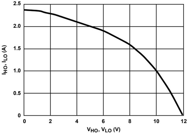
FIGURE 12. PEAK PULLUP CURRENT vs OUTPUT VOLTAGE
