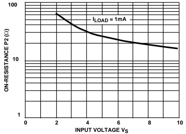
FIGURE 2. ON-RESISTANCE SWITCH P2 AS A FUNCTION OF INPUT VOLTAGE V<sub>S</sub>
