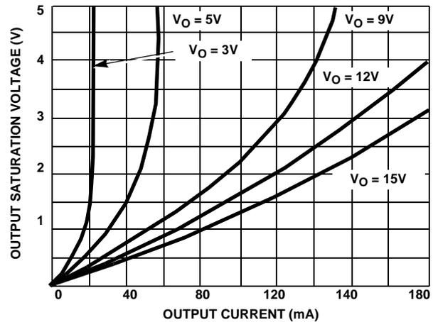
FIGURE 4. P<sub>BAR</sub> OR S<sub>BAR</sub> SATURATION VOLTAGE AS A FUNCTION OF OUTPUT CURRENT
