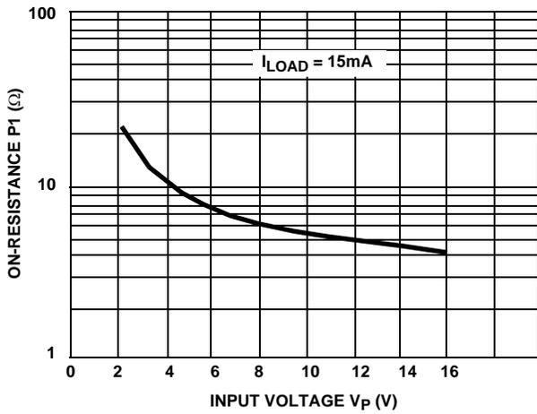
FIGURE 1. ON-RESISTANCE SWITCH P1 AS A FUNCTION OF INPUT VOLTAGE V<sub>P</sub>
