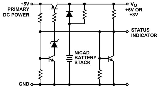
FIGURE 6. DISCRETE BATTERY BACKUP CIRCUIT
