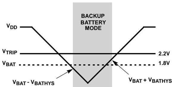
FIGURE 9. BATTERY SWITCHOVER WHEN V<sub>BAT</sub> < V<sub>TRIP</sub>
