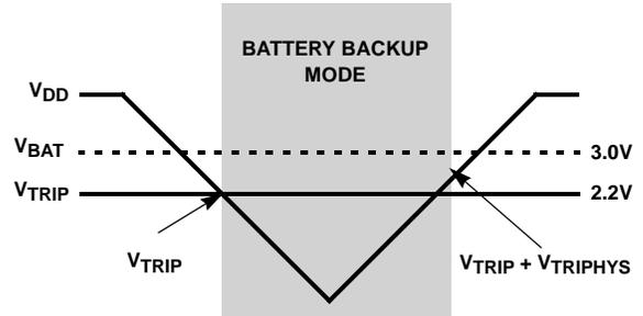
FIGURE 10. BATTERY SWITCHOVER WHEN V<sub>BAT</sub> > V<sub>TRIP</sub>
