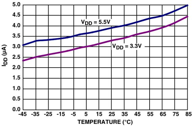
FIGURE 3.  $I_{DD3}$  vs TEMPERATURE
