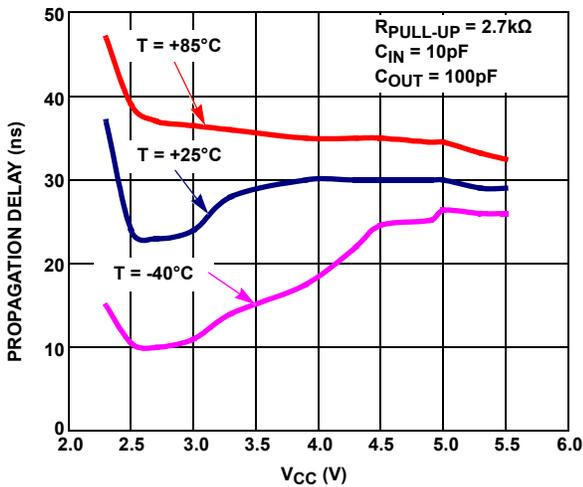
FIGURE 23. PROPAGATION DELAY H-L vs  $V_{CC}$
