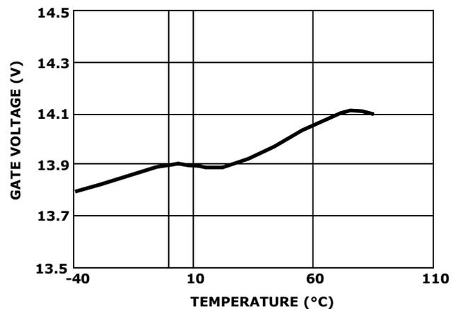
FIGURE 15. GATE VOLTAGE (AT V<sub>DD</sub> = 80V)
