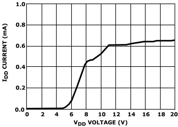
FIGURE 12. I<sub>DD</sub> vs V<sub>DD</sub> (<20V)
