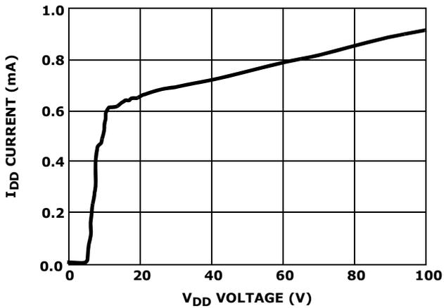
FIGURE 10. I<sub>DD</sub> vs V<sub>DD</sub>
