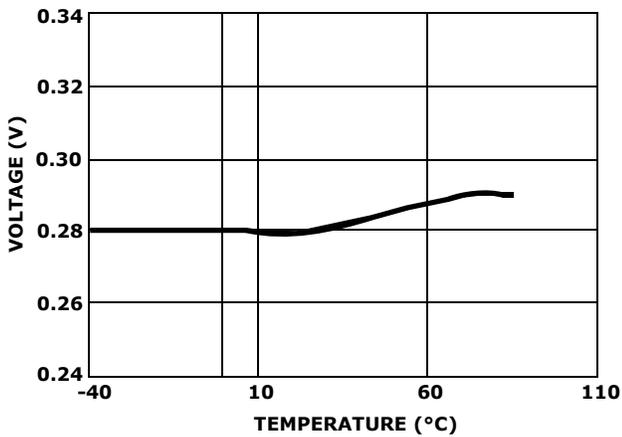
FIGURE 20. PWRGD (ISL6140) VOL (AT 1mA) VOLTAGE
