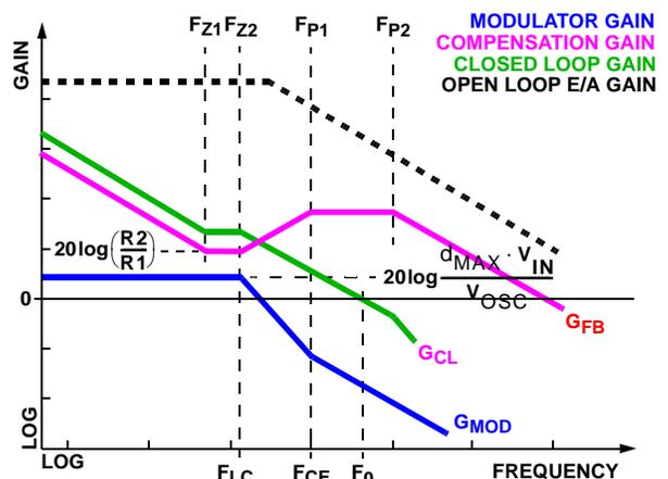
**FIGURE 9. ASYMPTOTIC BODE PLOT OF CONVERTER GAIN**
