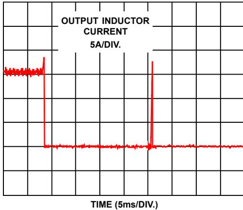
FIGURE 1. OVERCURRENT OPERATION
