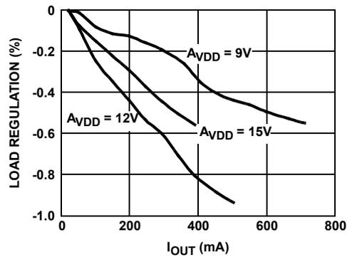
FIGURE 6.  $V_{\text{BOOST}}$  LOAD REGULATION AT  $V_{\text{IN}} = 5\text{V}$  (PI-MODE)
