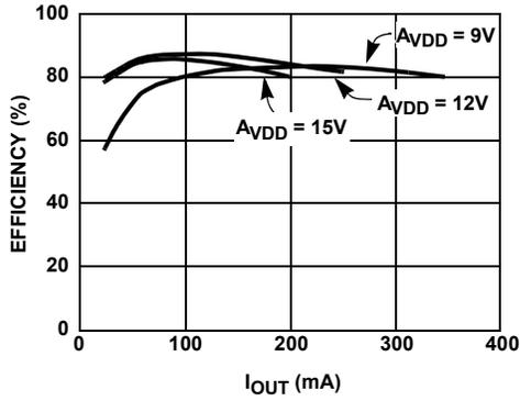
FIGURE 1.  $V_{\text{BOOST}}$  EFFICIENCY AT  $V_{\text{IN}} = 3\text{V}$  (PI-MODE)
