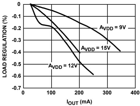
FIGURE 5.  $V_{\text{BOOST}}$  LOAD REGULATION AT  $V_{\text{IN}} = 3\text{V}$  (PI-MODE)
