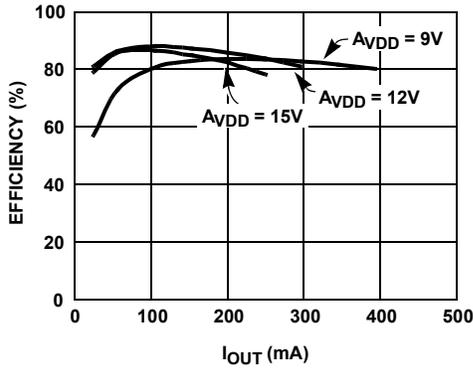
FIGURE 3.  $V_{\text{BOOST}}$  EFFICIENCY AT  $V_{\text{IN}} = 3\text{V}$  (P-MODE)
