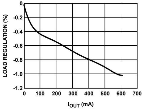
FIGURE 13. V<sub>LOGIC</sub> LOAD REGULATION
