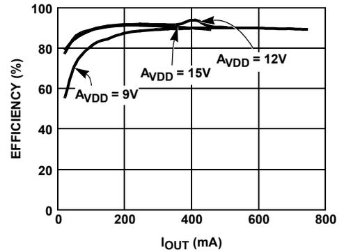
FIGURE 4.  $V_{\text{BOOST}}$  EFFICIENCY AT  $V_{\text{IN}} = 5\text{V}$  (P-MODE)
