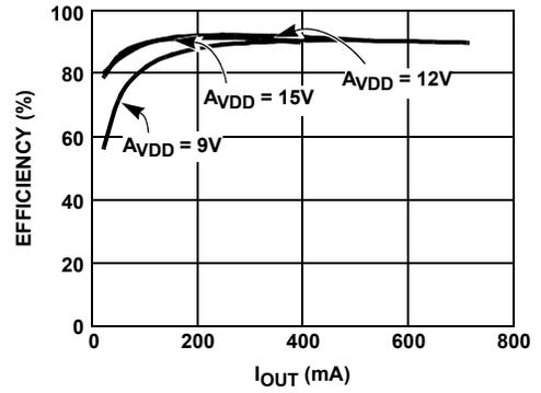
FIGURE 2.  $V_{\text{BOOST}}$  EFFICIENCY AT  $V_{\text{IN}} = 5\text{V}$  (PI-MODE)
