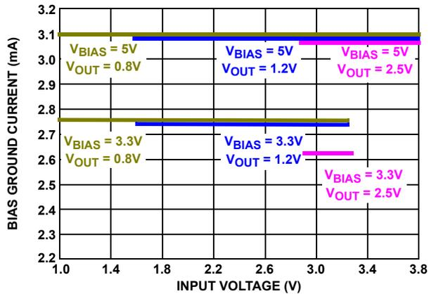
FIGURE 15. BIAS GROUND CURRENT vs  $V_{\text{IN}}$  and  $V_{\text{OUT}}$
