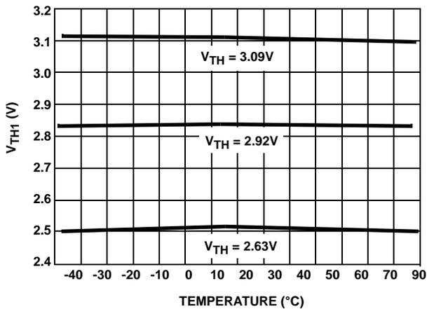
FIGURE 8.  $V_{TH1}$  vs TEMPERATURE < 5V SUPPLY
