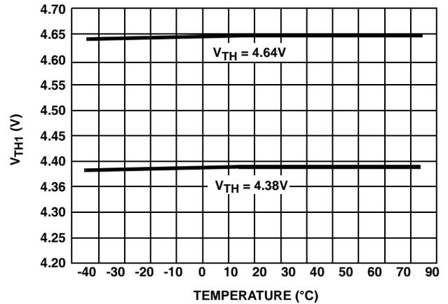
FIGURE 7.  $V_{TH1}$  vs TEMPERATURE FOR 5V SUPPLY
