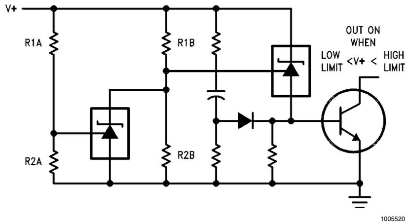
$$LOW\ LIMIT \approx V_{REF} \left(1 + \frac{R1B}{R2B}\right) + V_{BE}$$
