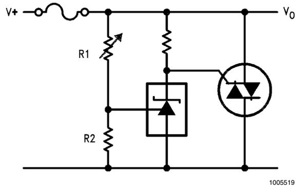
$$V_{LIMIT} \approx \left(1 + \frac{R1}{R2}\right) V_{REF}$$
