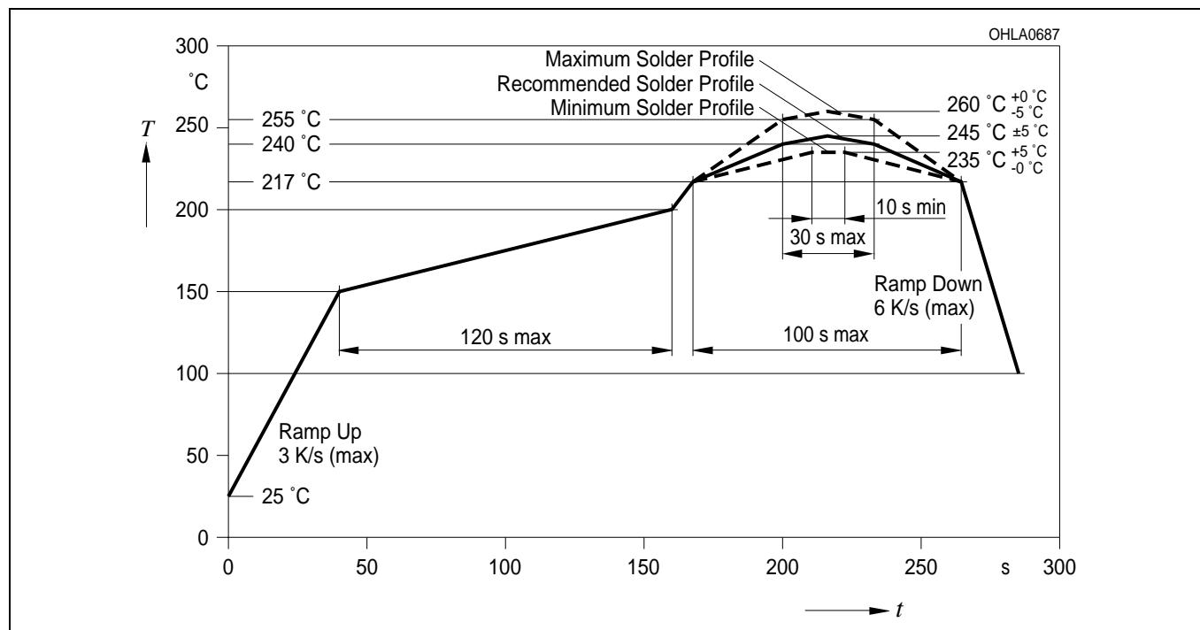
**Wellenlöten (TTW)****TTW Soldering**
