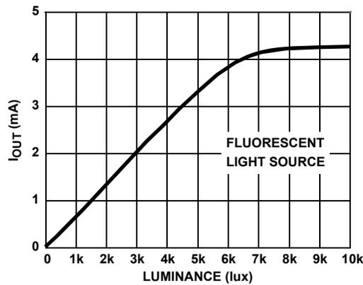
FIGURE 9. I<sub>OUT</sub> vs LUMINANCE
