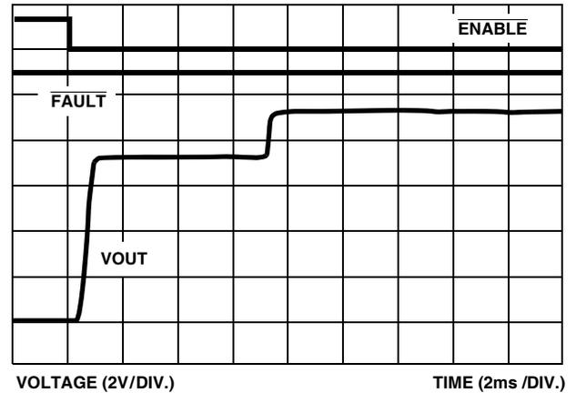
FIGURE 11. ISL6436L TURN-ON INTO 1.5A MOMENTARY OC
