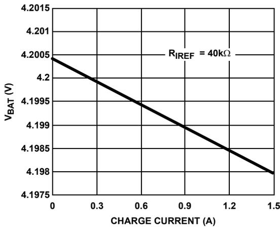
**FIGURE 1. CHARGER OUTPUT VOLTAGE vs CHARGE CURRENT**
