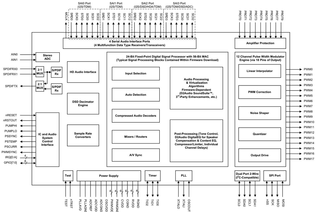
FIGURE 4. D2-7xx83 IC FUNCTIONAL BLOCK DIAGRAM
