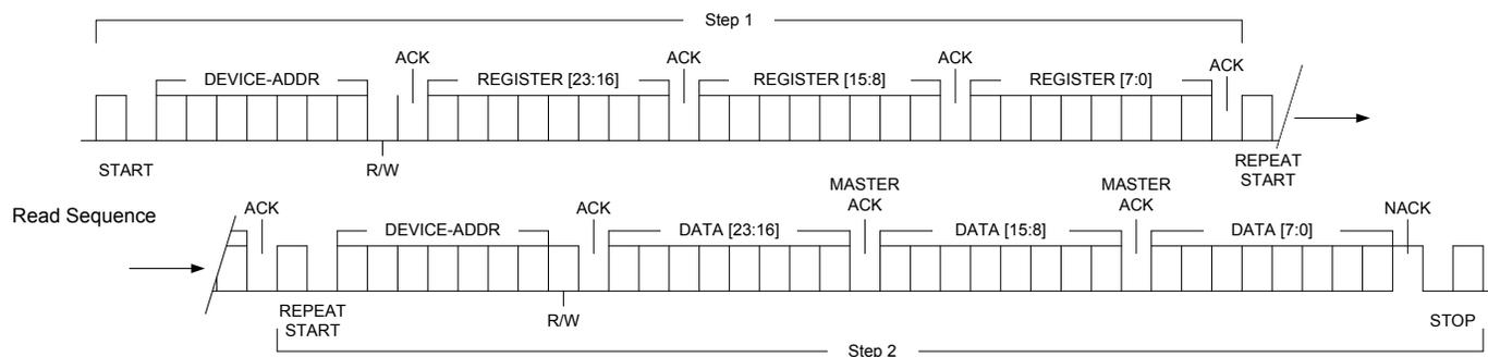
FIGURE 11. I<sup>2</sup>C READ SEQUENCE OPERATION
