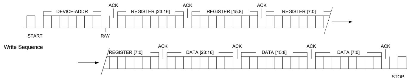
FIGURE 10. I<sup>2</sup>C WRITE SEQUENCE OPERATION
