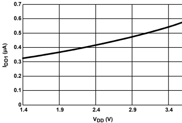
FIGURE 2. I<sub>DD1</sub> vs V<sub>DD</sub>
