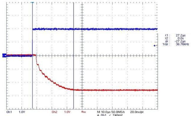
FIGURE 20. CHARGE PUMP RESPONSE FOR SDB GOING LOW
