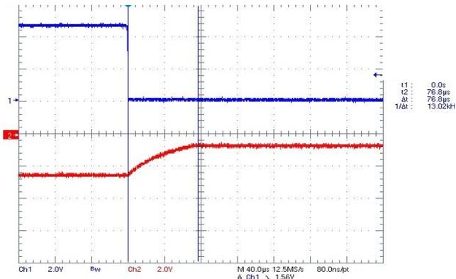
FIGURE 19. CHARGE PUMP RESPONSE FOR SDB GOING HIGH
