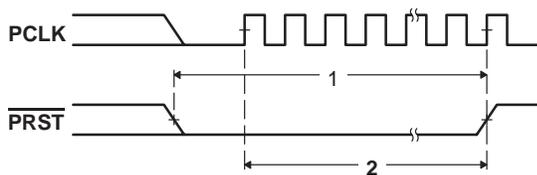
Figure 48. PCI Reset ( $\overline{\text{PRST}}$ ) Timing
