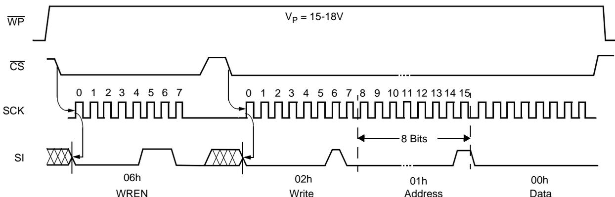
FIGURE 1. SET V<sub>TRIP</sub> LEVEL SEQUENCE (V<sub>CC</sub> = DESIRED V<sub>TRIP</sub> VALUE.)
