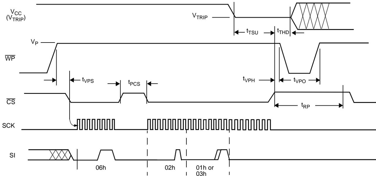
**$V_{TRIP}$  Programming Parameters**
