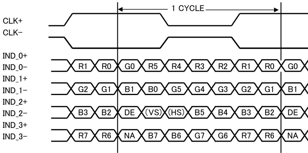
4-3. LVDSインターフェイスブロック図 LVDS interface block diagram
