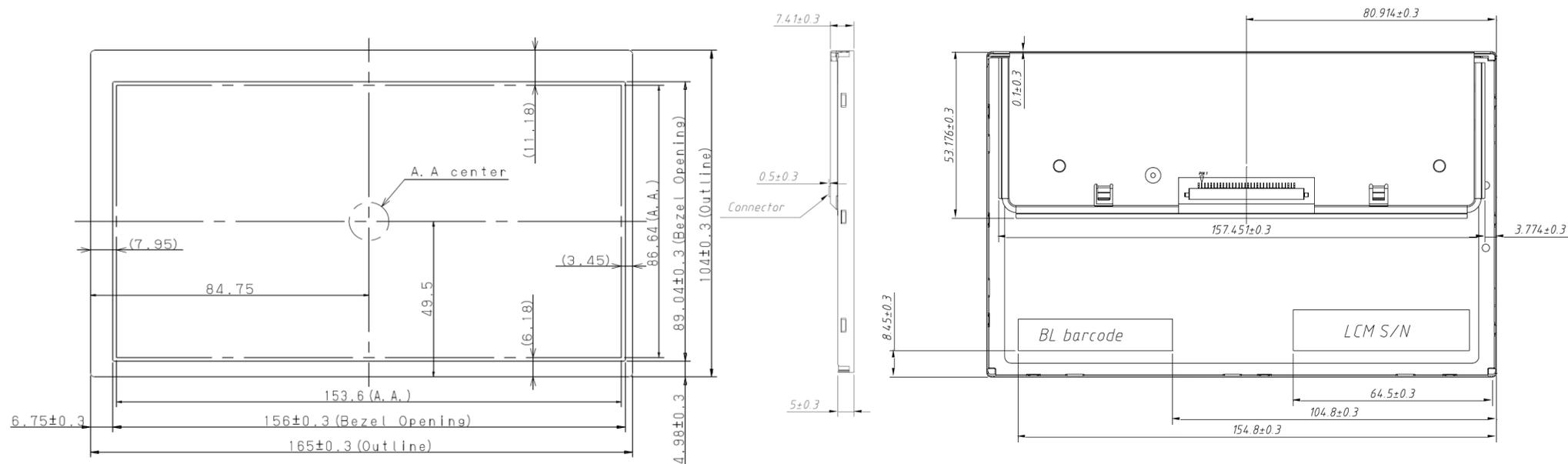
图1 : LQ070Y3LG05外形尺寸图
