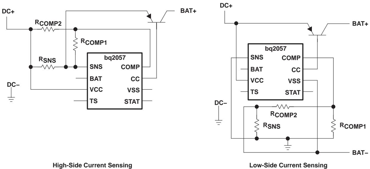
**Figure 13. AutoComp Circuits**
