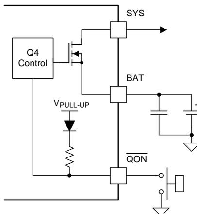
Figure 19.  $\overline{QON}$  Circuit
