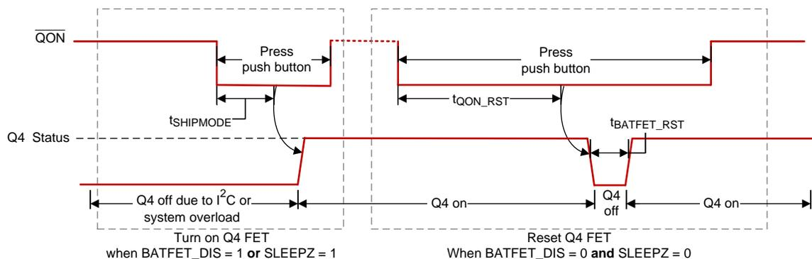
Figure 18.  $\overline{\text{QON}}$  Timing
