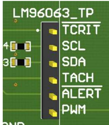
Figure 8. LM96063 Test Points
