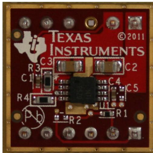
**Figure 1. SMP-TPS7A3001-MVK Submodule**
