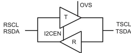
**Figure 19. I<sup>2</sup>C Drivers in TMDS141**
