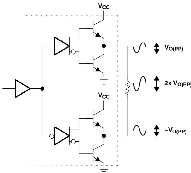
**Figure 24. Bridge-Tied-Load Configuration**
