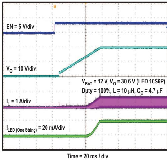
Figure 23. LED DRIVER POWER ON SEQUENCE
