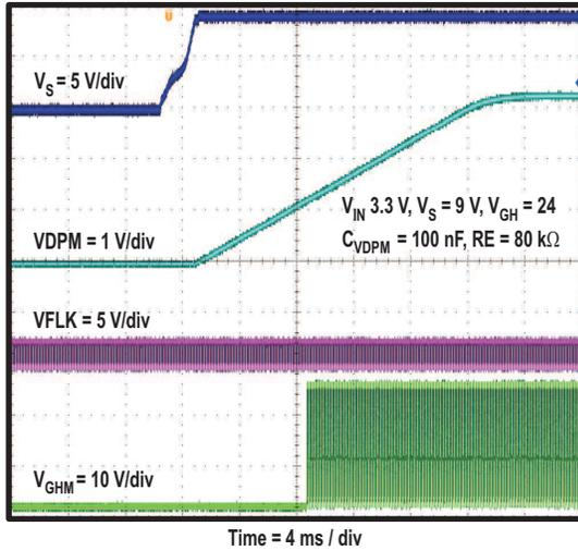
Figure 13. POWER ON SEQUENCE OF VGHM
