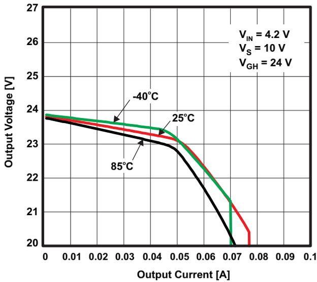
Figure 7. POSITIVE CHARGE PUMP VOLTAGE vs LOAD CURRENT
