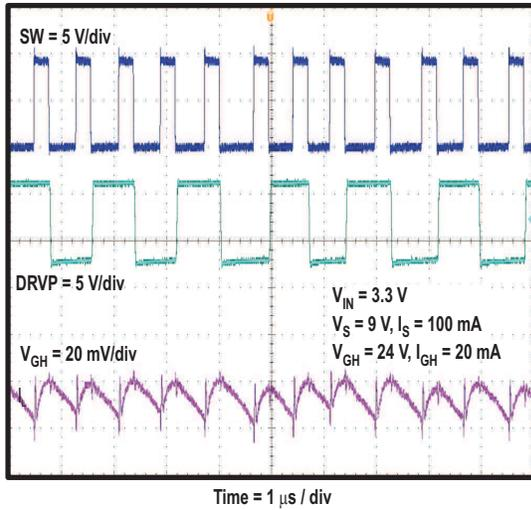
Figure 5. POSITIVE CHARGE PUMP OUTPUT VOLTAGE RIPPLE
