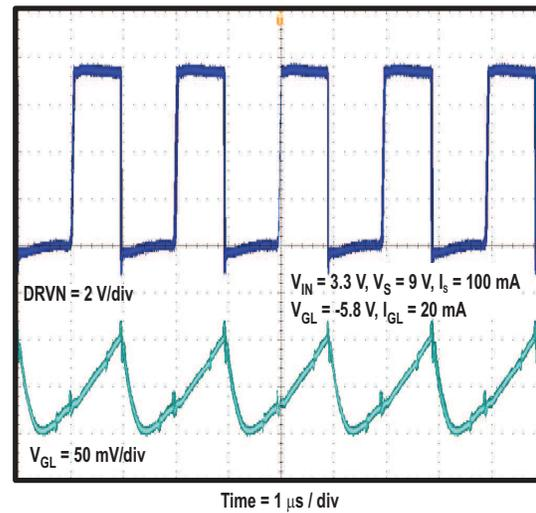
Figure 8. NEGATIVE CHARGE PUMP OUTPUT VOLTAGE RIPPLE
