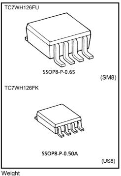
SSOP8-P-0.65 : 0.02 g (typ.) SSOP8-P-0.50A : 0.01 g (typ.)
