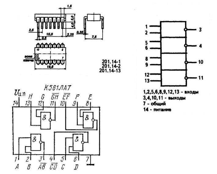
Микросхемы **К176ЛА7** и **К561ЛА7** содержат по четыре двухвходовых базовых элемента **И** с инверсией выходного сигнала. Технические данные можно посмотреть в таблице.
