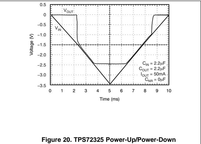
Figure 20. TPS72325 Power-Up/Power-Down
